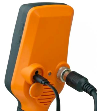
Schließen Sie das Micro-USB-Kabel an ein Ladegerät mit USB-Port an. Die Batteriestandsanzeige hört auf zu blinken, wenn das Gerät vollständig aufgeladen ist. Geben Sie dem X10 4 Stunden Zeit, um aufzuladen.
