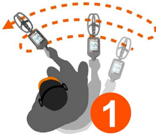
**Schwingen** Schwingen Sie die Spule ca. 4 cm über dem Boden. Überlappen Sie die Schwenkbewegungen, um das Übersehen von Objekten zu vermeiden.
