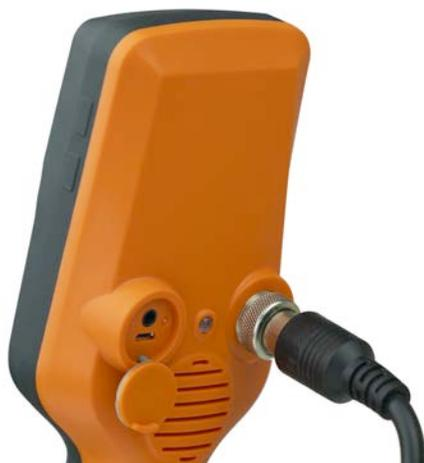
Entfernen Sie die Feuchtigkeit- und Staubschutzkappe, um Zugang zu den Anschlüssen zu erhalten. Bringen Sie sie wieder an, um Schäden durch Schmutz oder Feuchtigkeit vorzubeugen.
